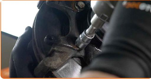
**14** Entfernen Sie die Sattelhalterung.
