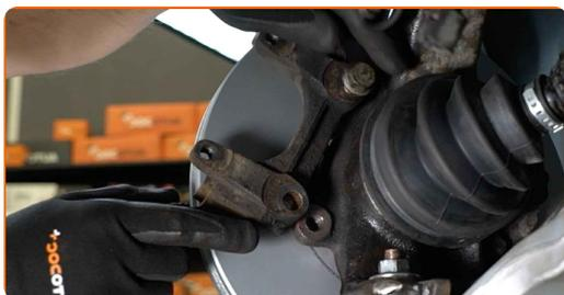
**20** Befestigen Sie die Bremssattelhalterung. Verwenden Sie Stecknuss Nr. 17. Verwenden Sie einen Drehmomentschlüssel. Ziehen Sie ihn mit 125 Nm Drehmoment fest.
