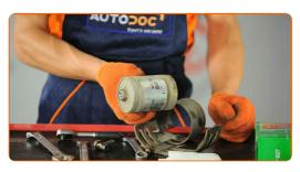
Installieren Sie einen neuen Kraftstofffilter.
