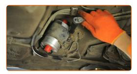
Befestigen Sie die Leitung am Kraftstofffilter.
