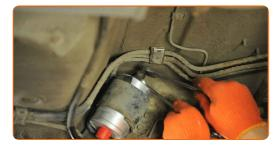
Befestigen Sie die Leitung am Kraftstofffilter.
