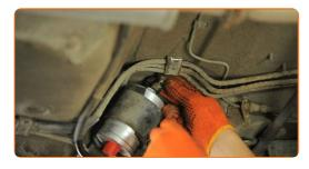
Schrauben Sie das Befestigungselement ein, das die Kraftstoffversorgungsleitung mit dem Kraftstofffiltergehäuse verbindet. Verwenden Sie Ring-Gabelschlüssel Nr. 17. Verwenden Sie Ring-Gabelschlüssel Nr. 22.
