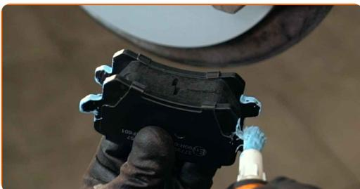
Austausch: Bremsbeläge – AUDI Q3 (8UB, 8UG). Tipp:
