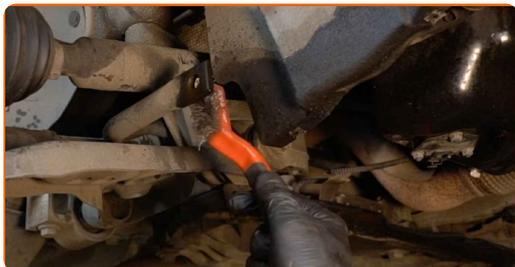
**11** Montieren Sie den Querlenker.
