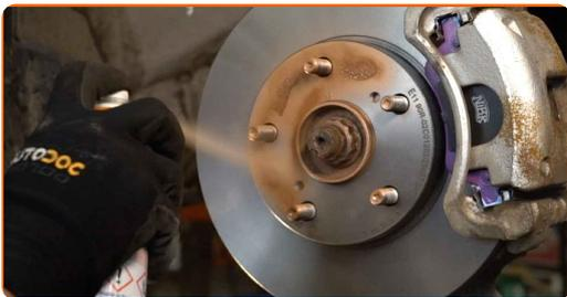
**16** Die Bremsscheibenoberfläche reinigen. Benutzen Sie einen Bremsenreiniger.
