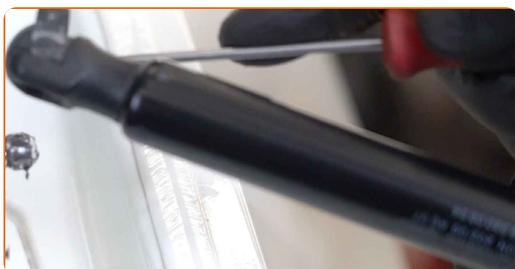
**6** Reinigen Sie den Montagesitz des Heckklappendämpfers.
