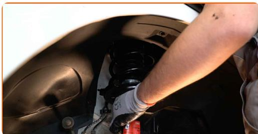
**40** Schrauben Sie die obere Befestigung des Domlagers an. Schrauben Sie diese nicht fest.
