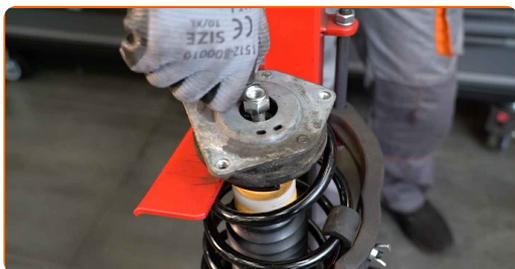
**34** Ziehen Sie die Federbeinkolbenstangenmutter an. Verwenden Sie Stecknuss Nr. 22. Verwenden Sie Inbusschlüssel Nr. H6. Verwenden Sie einen Drehmomentschlüssel. Ziehen Sie ihn mit 60 Nm Drehmoment fest.
