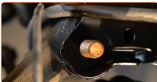
**43** Schrauben Sie das Befestigungselement ein, das das Federbein mit dem Achsschenkel verbindet. Verwenden Sie Ring-Gabelschlüssel Nr. 21. Verwenden Sie Stecknuss Nr. 21. Verwenden Sie einen Ratschenschlüssel.
