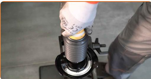
**31** Installieren Sie die Feder am Stoßdämpfer.
