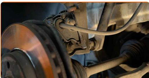
**14** Die Befestigungselemente, die das Federbein mit dem Achsschenkel verbinden, reinigen. Benutzen Sie eine Drahtbürste. Benutzen Sie WD-40-Spray.
