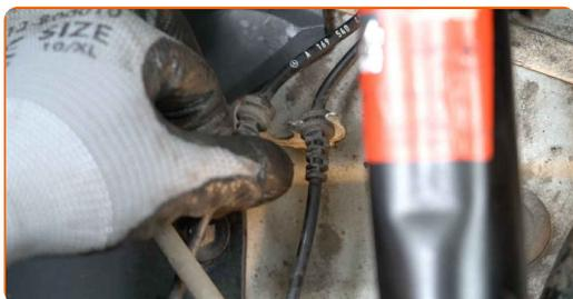
**48** Verbinden Sie den Stecker des Verschleißsensors der Bremsbeläge.
