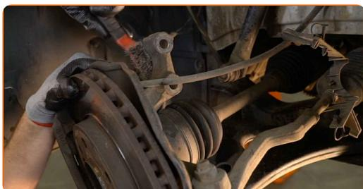
**39** Installieren Sie das Federbein am Radlauf.
