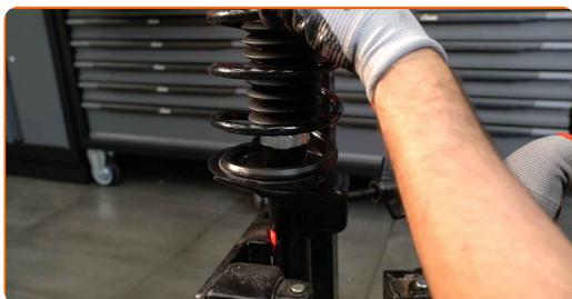
**37** Entfernen Sie das zusammengebaute Federbein.
