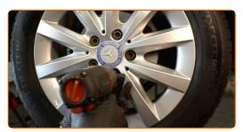
Senken Sie das Auto und ziehen Sie die Radschrauben über Kreuz an. Verwenden Sie eine Schlagnuss für Felgen # H12. Verwenden Sie einen Drehmomentschlüssel. Ziehen Sie ihn mit 130 Nm Drehmoment fest.
