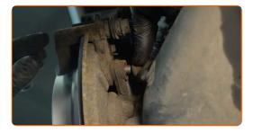
Befestigen Sie die Bremssattelhalterung. Verwenden Sie Stecknuss Nr. 16. Verwenden Sie einen Drehmomentschlüssel. Ziehen Sie ihn mit 55 Nm Drehmoment fest.
