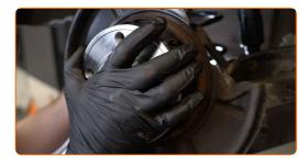
Ziehen Sie das Befestigungselement des Radnabenlagers an. Verwenden Sie Stecknuss Nr. E16. Verwenden Sie einen Drehmomentschlüssel. Ziehen Sie ihn mit 120 Nm Drehmoment fest.
