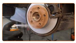
Die Bremsscheibenoberfläche reinigen. Benutzen Sie einen Bremsenreiniger.
