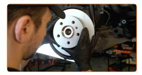
Ziehen Sie die Befestigung der Bremsscheibe fest. Verwenden Sie den Torx T30. Verwenden Sie einen Drehmomentschlüssel. Ziehen Sie ihn mit 9 Nm Drehmoment fest.
