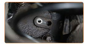
Schrauben Sie die Nabenlagerhalterung ab. Verwenden Sie Stecknuss Nr. E16. Verwenden Sie einen Ratschenschlüssel.
