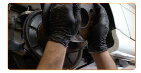
Reinigen Sie die Befestigungen des Radnabenlagers. Benutzen Sie eine Drahtbürste. Benutzen Sie WD-40-Spray.
