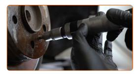
16 Entfernen Sie die Bremsscheibe.
