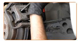
Entfernen Sie den Bremssattel.
