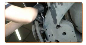
13 Entfernen Sie die Sattelhalterung.
