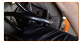
Entfernen Sie die Nabe und das Lager zusammen, da sie eine versiegelte Einheit sind. Verwenden Sie den Schlaghammer-Nabenabzieher.
