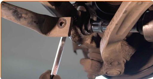
**22** Entfernen Sie die Befestigungsschraube.
