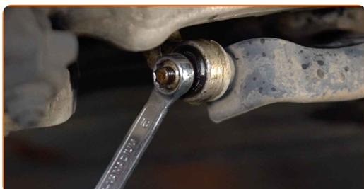
**18** Schrauben Sie das Befestigungselement heraus, das den Stabilisator mit dem Querlenker verbindet. Verwenden Sie Ring-Gabelschlüssel Nr. 16 (2 Teile).
