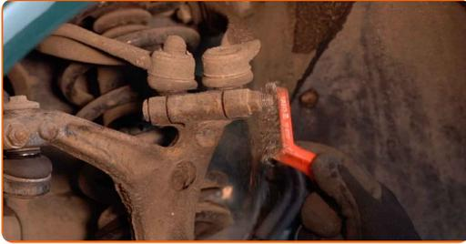
**13** Schrauben Sie die oberen Steuerarmverschlüsse ab (2 Stück). Verwenden Sie Ring-Gabelschlüssel Nr. 16. Verwenden Sie Stecknuss Nr. 16.
