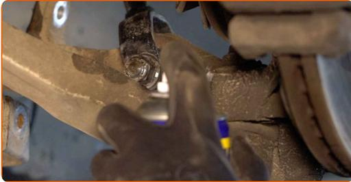
**21** Untere Befestigung der Stoßdämpferfedern abschrauben. Verwenden Sie Stecknuss Nr. 18. Verwenden Sie Ring-Gabelschlüssel Nr. 18.
