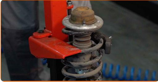
**31** Behandeln Sie die Federbeinstange. Benutzen Sie eine Drahtbürste. Benutzen Sie WD-40-Spray.
