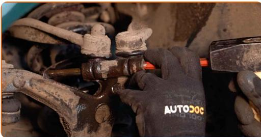
**15** Trennen Sie den oberen Querlenker vom Achsschenkel (2 Stück). Benutzen Sie ein Brecheisen.
