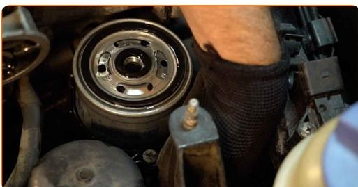
**12** Installieren Sie einen neuen Kraftstofffilter.
