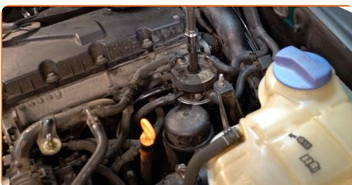
**16** Bringen Sie den Anschluss des Kraftstoffdrucksensors an.
