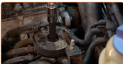
**8** Trennen Sie den Anschluss des Kraftstoffdrucksensors.
