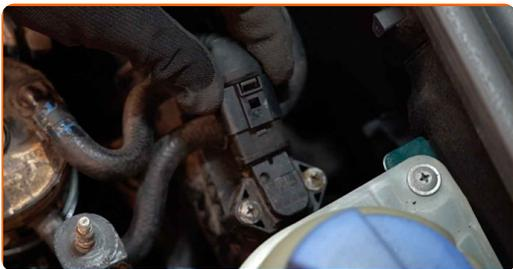
**9** Schrauben Sie die Kraftstofffilterabdeckung ab.
