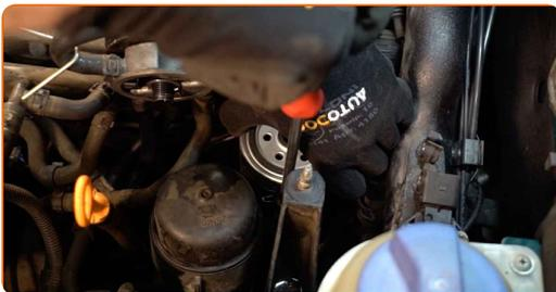
**14** Installieren Sie den Deckel des Kraftstofffiltergehäuse und ziehen Sie ihn an.
