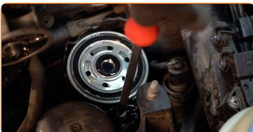
**11** Entfernen Sie den Kraftstofffilter. Legen Sie die alte Filterpatrone in den Behälter.
