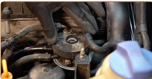
**15** Ziehen Sie die Befestigungen des Deckels des Kraftstofffiltergehäuses an. Verwenden Sie Inbusschlüssel Nr. H13. Verwenden Sie einen Drehmomentschlüssel. Ziehen Sie ihn mit 25 Nm Drehmoment fest.
