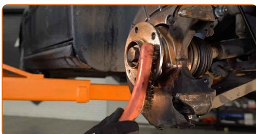
**15** Reinigen Sie die Befestigungen der Koppelstange. Benutzen Sie eine Drahtbürste. Benutzen Sie WD-40-Spray.
