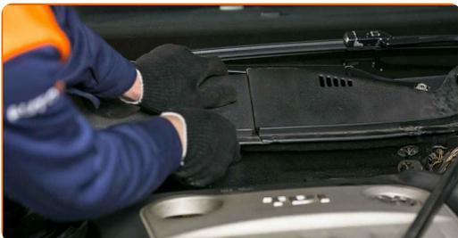
**49** Bringen Sie die Befestigungselemente der Windlaufabdeckung an.
