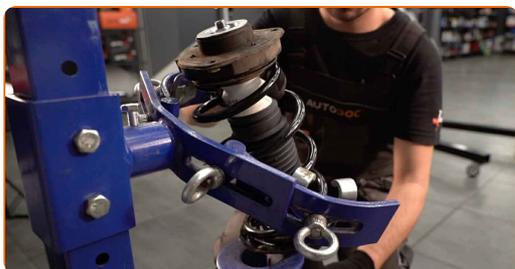
**44** Reinigen Sie die Anbringungssitze des Federbeins. Benutzen Sie eine Drahtbürste. Benutzen Sie WD-40-Spray.
