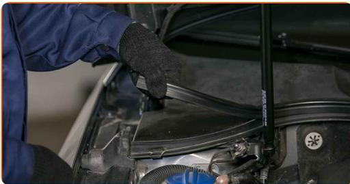
**29** Entfernen Sie die Befestigungsclips der Windlaufabdeckung.
