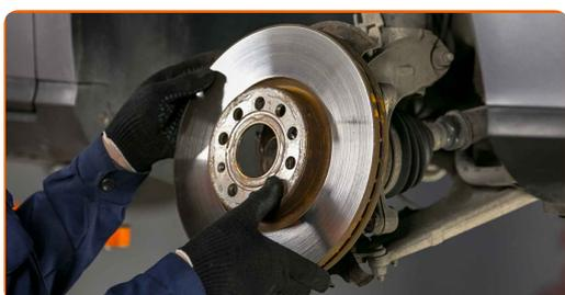
**14** Reinigen Sie die Nabe. Benutzen Sie eine Drahtbürste. Behandeln Sie die Kontaktfläche. Benutzen Sie ein Kupferschmiermittel.
