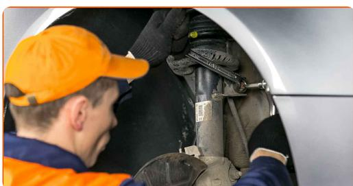
**17** Reinigen Sie das Befestigungselement, das den Spurstangenkopf mit dem Achsschenkel verbindet. Benutzen Sie eine Drahtbürste. Benutzen Sie WD-40-Spray.
