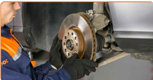
**59** Ziehen Sie die Befestigung der Bremsscheibe fest. Verwenden Sie den Torx T30. Verwenden Sie einen Drehmomentschlüssel. Ziehen Sie ihn mit 4 Nm Drehmoment fest.
