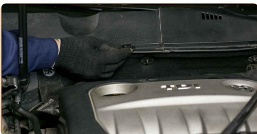
**50** Bauen Sie die Dichtung der Windabweiserabdeckung ein. Entfernen Sie die Kotflügel-Abdeckung.
