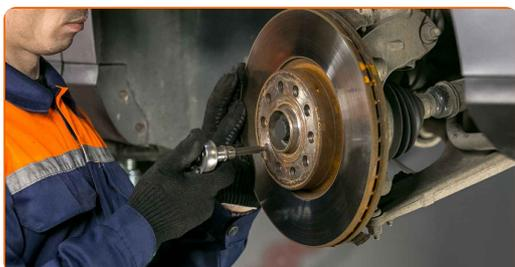
**13** Entfernen Sie die Bremsscheibe.
