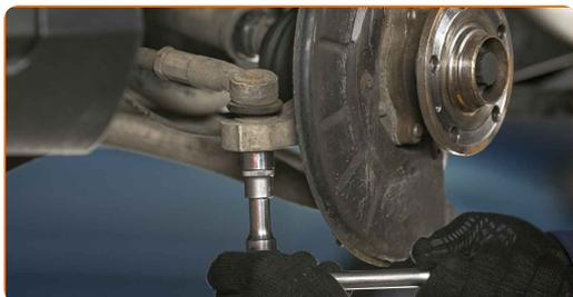
**19** Ziehen Sie den Spurstangenkopf vom Achsschenkel. Verwenden Sie einen Kugelgelenkabzieher.
