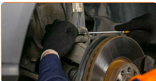
**7** Trennen Sie die ABS-Sensor Steckdose. Verwenden Sie einen flachen Schraubendreher.
