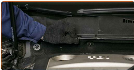
**30** Heben Sie die Windabweiserabdeckung an und entfernen Sie dieses.
