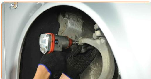
**20** Ziehen Sie die Spurstangenkopf Sicherungsmutter an. Verwenden Sie Ring-Gabelschlüssel Nr. 19. Verwenden Sie Ring-Gabelschlüssel Nr. 22. Verwenden Sie einen Drehmomentschlüssel. Ziehen Sie ihn mit 40 Nm Drehmoment fest.
