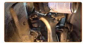
Lösen Sie das Ende der Befestigungsmutter an dem Achsschenkel. Verwenden Sie Stecknuss Nr. 13. Verwenden Sie einen Ratschenschlüssel.
