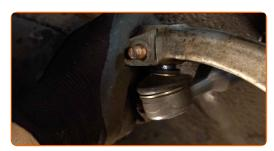
Schrauben Sie die Befestigungsmutter auf, die den Spurstangenkopf mit dem Achsschenkel verbindet. Verwenden Sie Stecknuss Nr. 13. Verwenden Sie einen Ratschenschlüssel.
