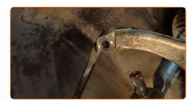
Schrauben Sie das Ende aus der Zugstange. Benutzen Sie einen Rollgabelschlüssel.
