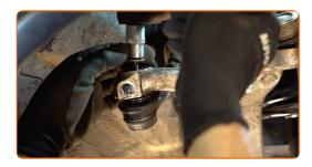
Entfernen Sie die Befestigungsschraube. Verwenden Sie einen flachen Metallmeißel. Benutzen Sie einen Hammer.
