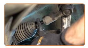
Ziehen Sie den Spurstangenkopf vom Achsschenkel. Verwenden Sie einen flachen Metallmeißel. Benutzen Sie einen Hammer.
