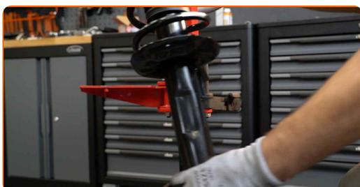
**48** Installieren Sie das Federbein am Radlauf.
