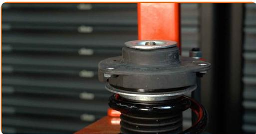
**44** Ziehen Sie die Federbeinkolbenstangenmutter an. Verwenden Sie Stecknuss Nr. 19. Verwenden Sie Inbusschlüssel Nr. H6. Verwenden Sie einen Drehmomentschlüssel. Ziehen Sie ihn mit 60 Nm Drehmoment fest.
