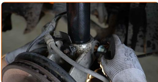
**53** Schrauben Sie das Befestigungselement ein, das das Federbein mit dem Achsschenkel verbindet. Verwenden Sie Stecknuss Nr. 18. Benutzen Sie den XZN #14. Verwenden Sie einen Ratschenschlüssel.
