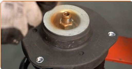
**46** Dekomprimieren Sie die Feder.
