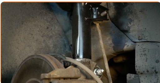
**63** Ziehen Sie das Befestigungselement an, das die Druckstange mit dem Federbein verbindet. Verwenden Sie Stecknuss Nr. 18. Verwenden Sie einen Drehmomentschlüssel. Ziehen Sie ihn mit 65 Nm Drehmoment fest.
