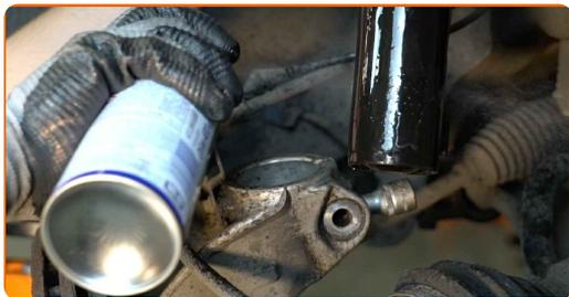
**51** Befestigen Sie das Dämpferbein auf dem Achsschenkel.
