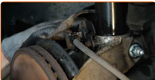
**62** Montieren Sie den Querlenker.
