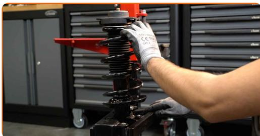
**47** Entfernen Sie das zusammengebaute Federbein.
