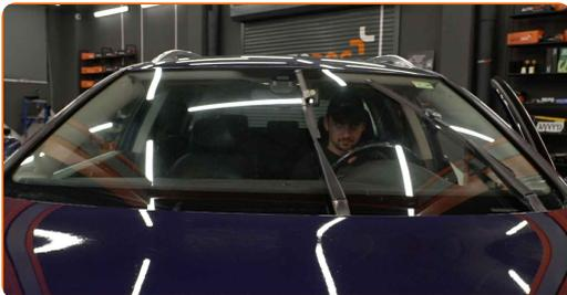
**2** Schalten Sie die Zündung ab. Im Wartungsmodus befinden sich die Wischer in der oberen Position.
