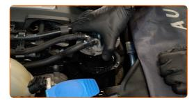
6 Entfernen Sie den Kraftstofffilter.
