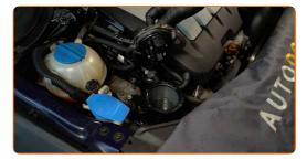
Installieren Sie einen neuen Kraftstofffilter.
