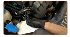
Entfernen Sie das Mikrofasertuch vom Kraftstofffiltergehäuse.
