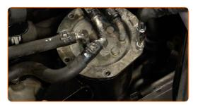
Ziehen Sie die Befestigungen des Deckels des Kraftstofffiltergehäuses an. Verwenden Sie den Torx T20. Verwenden Sie einen Ratschenschlüssel. Verwenden Sie einen Drehmomentschlüssel. Ziehen Sie ihn mit 9 Nm Drehmoment fest.
