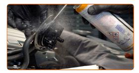
Entfernen Sie den Gummistreifen. Verwenden Sie einen flachen Schraubendreher.
