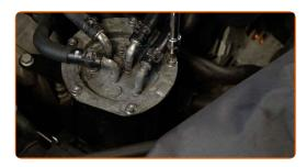
Heben Sie den Kraftstofffilterdeckel ein wenig an. Benutzen Sie ein Brecheisen.
