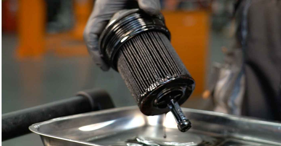
15 Legen Sie die alte Filterpatrone in den Behälter.
