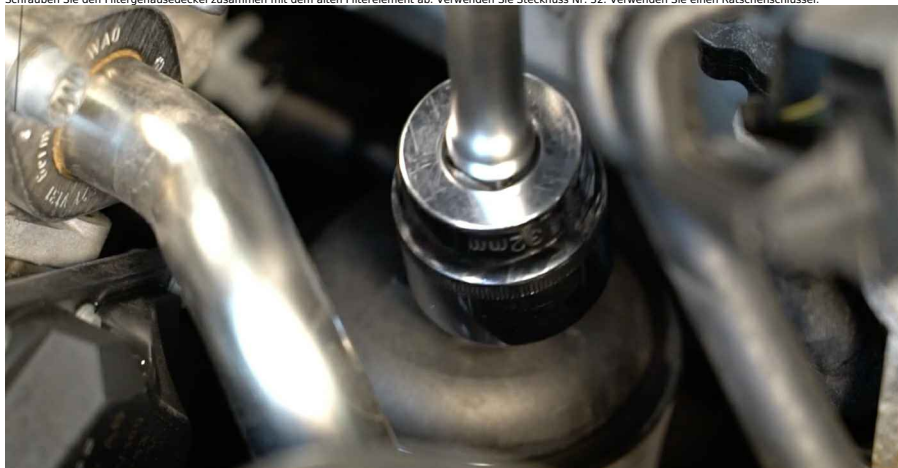
12 Schrauben Sie den Filtergehäusedeckel zusammen mit dem alten Filterelement ab. Verwenden Sie Stecknuss Nr. 32. Verwenden Sie einen Ratschenschlüssel.
