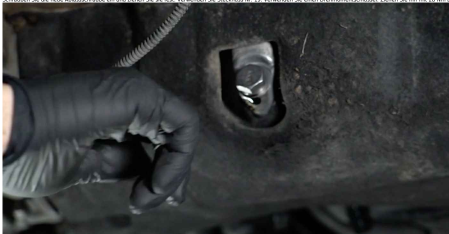
21 Reinigen Sie den Bereich um die Ablassöffnung der Ölwanne. Verwenden Sie Allzweckreinigungsspray.
