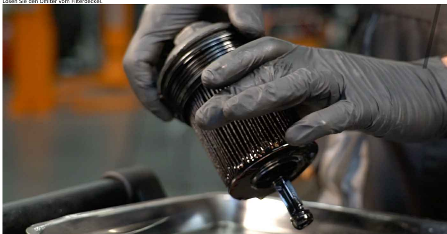
17 Den Dichtungsring des Ölfilterdeckels entfernen. Verwenden Sie einen flachen Schraubendreher.
