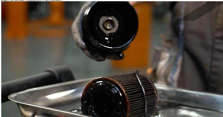
16 Lösen Sie den Ölfilter vom Filterdeckel.
