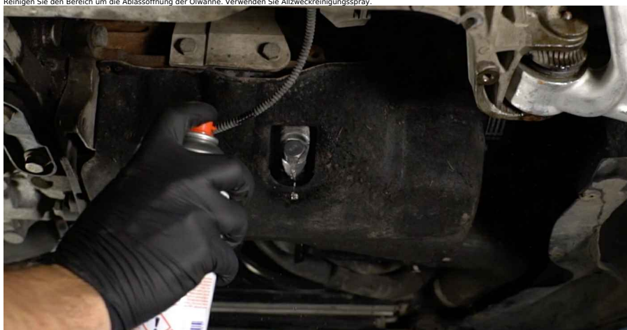
21 Reinigen Sie den Bereich um die Ablassöffnung der Ölwanne. Verwenden Sie Allzweckreinigungsspray.
