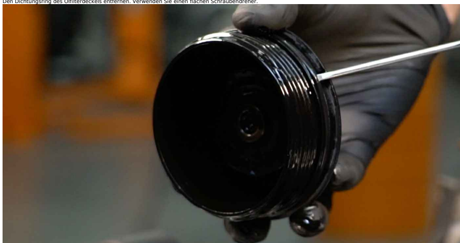
17 Den Dichtungsring des Ölfilterdeckels entfernen. Verwenden Sie einen flachen Schraubendreher.
