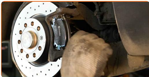
Austausch: Bremsbeläge – VW Passat Variant B6. Tipp von AUTODOC-Experten:
