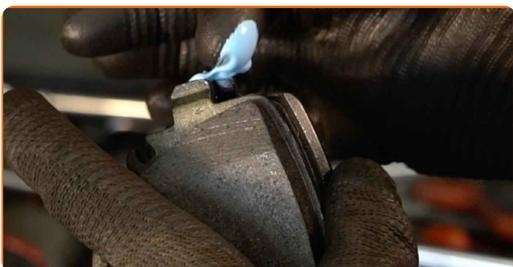
**Austausch: Bremsbeläge – VW Passat 3C B6 Variant. AUTODOC-Experten empfehlen:**
