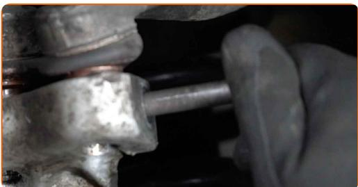
**11** Trennen Sie den oberen Querlenker vom Achsschenkel. Verwenden Sie einen flachen Metallmeißel. Benutzen Sie einen Hammer.
