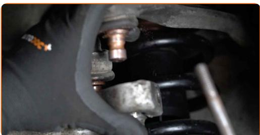
**12** Lösen Sie den unteren Bereich des Federbeins.
