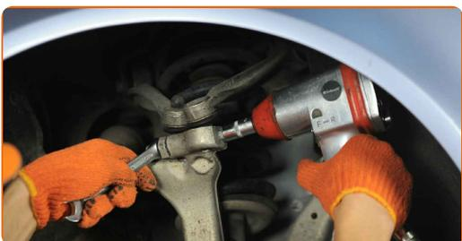
**10** Entfernen Sie die Befestigungsschraube.
