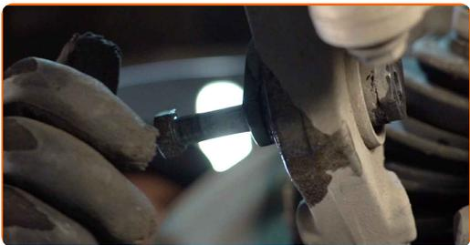
**9** Schrauben Sie die Befestigungen des unteren Arms ab. Verwenden Sie Ring-Gabelschlüssel Nr. 16. Verwenden Sie Stecknuss Nr. 16. Verwenden Sie einen Ratschenschlüssel.
