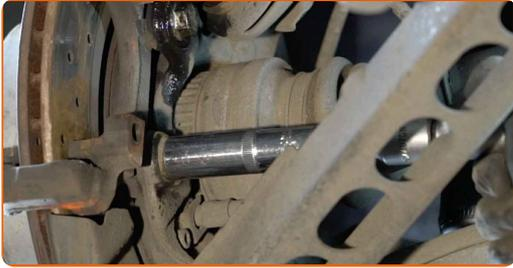
**19** Entfernen Sie die Sattelhalterung.
