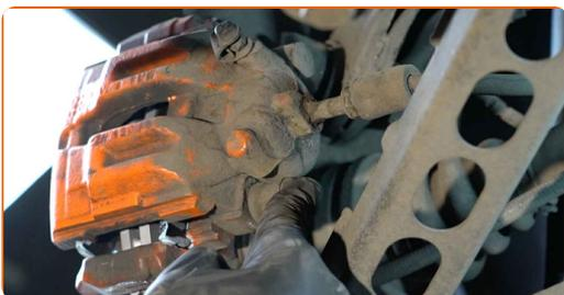
**35** Verbinden Sie den Bremsbelag-Verschleiß-Sensor.
