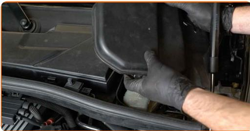
**4** Schrauben Sie die Kappe des Bremsflüssigkeitsausgleichsbehälters ab.
