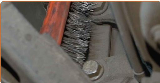
**18** Lösen Sie die Befestigung der Sattelhalterung. Verwenden Sie Stecknuss Nr. 16. Verwenden Sie ein Windeisen.
