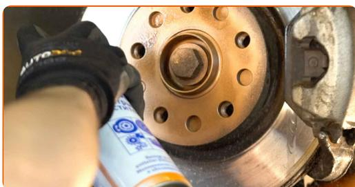
**69** Die Bremsscheibenoberfläche reinigen. Benutzen Sie einen Bremsenreiniger.
