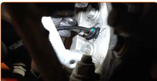
**16** Verbinden Sie das ABS mit der Sensorverdrahtung.
