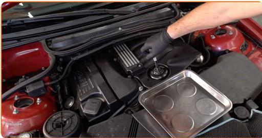
20 Schrauben Sie die Kappe an. Verwenden Sie Steckschlüssel 86/16 F. Verwenden Sie einen Drehmomentschlüssel. Ziehen Sie ihn mit 25 Nm Drehmoment fest.
