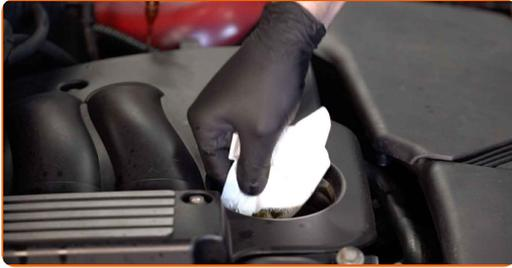
17 Reinigen Sie die Ölfilteraufnahme.
