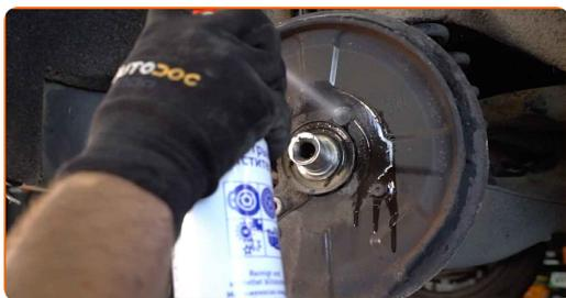
**19** Behandeln Sie die Befestigungsschrauben. Verwenden Sie ein Dichtmittel.
