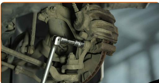
**8** Entfernen Sie die Befestigungsschrauben (2 Stück).
