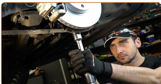
**16** Ziehen Sie das Befestigungselement an, das den Stabilisator mit dem Querlenker verbindet. Verwenden Sie Ring-Gabelschlüssel Nr. 17. Verwenden Sie Stecknuss Nr. 17. Verwenden Sie einen Drehmomentschlüssel. Ziehen Sie ihn mit 42 Nm Drehmoment fest.
