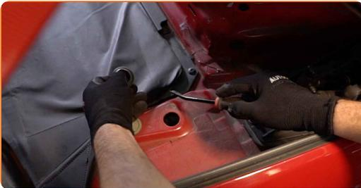
**3** Reinigen Sie die Befestigungselemente des Stoßdämpferdomlagers. Benutzen Sie WD-40-Spray.
