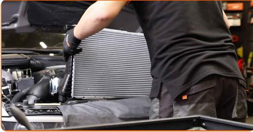
**18** Schrauben Sie die Befestigungen des Kühlers an. Verwenden Sie Stecknuss Nr. 8. Verwenden Sie einen Ratschenschlüssel.
