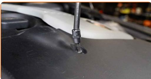
**44** Entfernen Sie die Kotflügel-Abdeckung.
