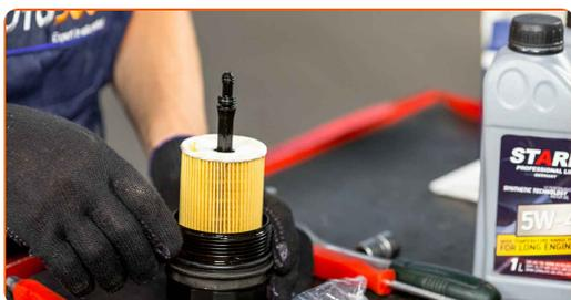
**25** Schrauben Sie den neuen Filter in seinen Platz. Verwenden Sie Steckschlüssel 86/16 F. Verwenden Sie einen Drehmomentschlüssel. Ziehen Sie ihn mit 23 Nm Drehmoment fest.
