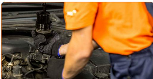
**19** Entfernen Sie das Filterelement aus dem Filtergehäuse.
