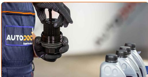
**20** Entfernen Sie die alten O-Ringe aus dem Ölfilterdeckel. Verwenden Sie einen flachen Schraubendreher.
