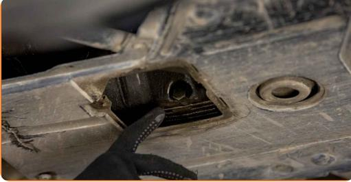
**6** Drehen Sie die Ablassschraube heraus. Verwenden Sie Stecknuss Nr. 17. Verwenden Sie einen Ratschenschlüssel.
