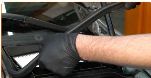
**7** Entfernen Sie das Luftfiltergehäuse.
