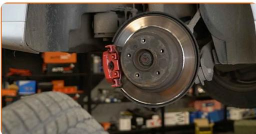
**14** Trennen Sie den Bremsbelag Verschleißsensor. Benutzen Sie ein Brecheisen.
