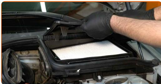
**6** Entfernen Sie die Abdichtung des Mikrofilterkastens.
