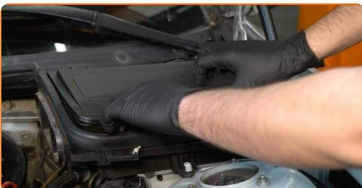
**5** Entfernen Sie den Gehäusedeckel des Innenraumfilters.
