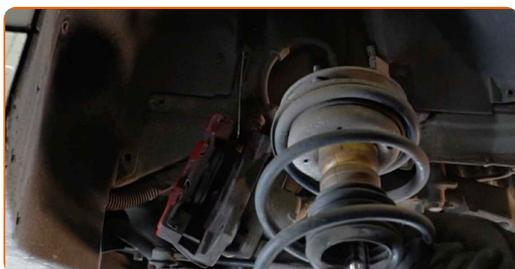
**40** Stellen Sie das Dämpferbein auf das Federspannwerkzeug.
