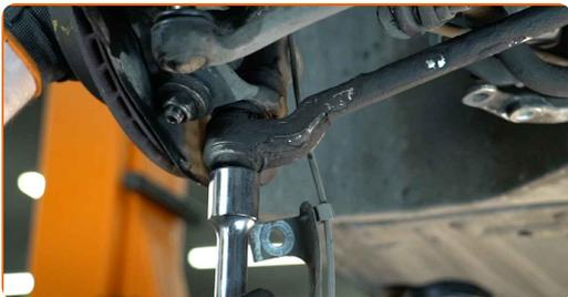
**68** Bauen Sie den Spurstangenkopf an dem Achsschenkel an.
