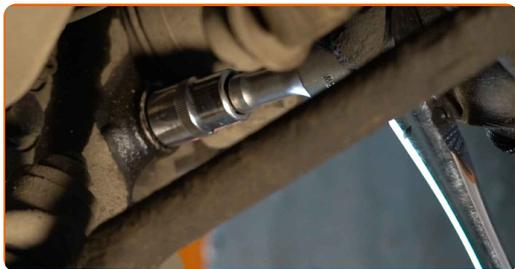
**15** Bauen Sie den Bremssattel inklusive dessen Halterung aus. Benutzen Sie ein Brecheisen.
