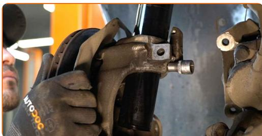
**60** Stützen Sie die Achsschenkel auf. Benutzen Sie einen hydraulischen Getriebeheber.
