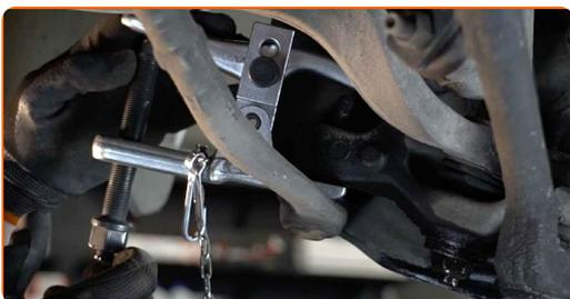
**22** Stützen Sie den Arm. Benutzen Sie einen hydraulischen Getriebeheber.
