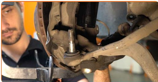
**61** Reinigen Sie die Montagebohrungen und die Gewinde des Querlenkers. Benutzen Sie eine Drahtbürste. Benutzen Sie WD-40-Spray.
