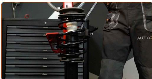
**55** Entfernen Sie das zusammengebaute Federbein.
