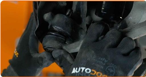
**69** Schrauben Sie die Befestigungsmutter auf, die den Spurstangenkopf mit dem Achsschenkel verbindet. Verwenden Sie Ring-Gabelschlüssel Nr. 18.
