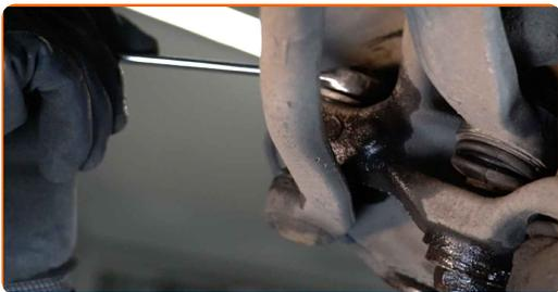
**21** Ziehen Sie den Spurstangenkopf vom Achsschenkel. Verwenden Sie einen Kugelgelenkabzieher.
