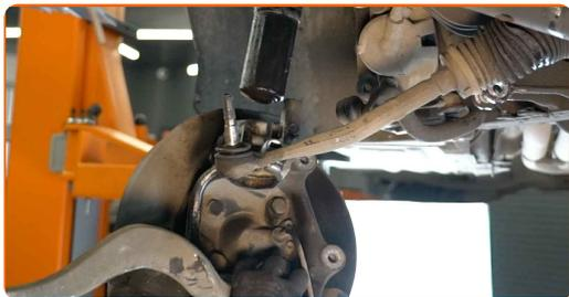
**38** Lösen Sie die obere Befestigung des Domlagers.
