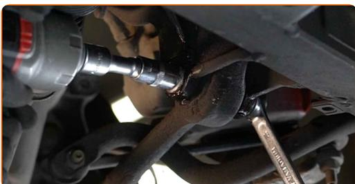
**33** Lösen Sie die hintere Befestigung des Querlenkers.
