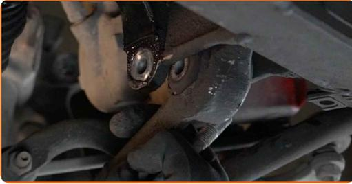
**34** Die Befestigungselemente, die das Federbein mit dem Achsschenkel verbinden, reinigen. Benutzen Sie eine Drahtbürste. Benutzen Sie WD-40-Spray.
