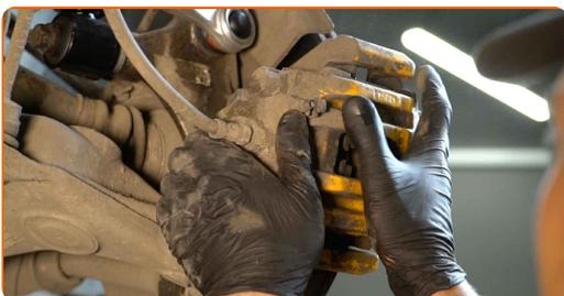
**27** Befestigen Sie die Bremssattelhalterung. Verwenden Sie Stecknuss Nr. 18. Verwenden Sie einen Drehmomentschlüssel. Ziehen Sie ihn mit 110 Nm Drehmoment fest.
