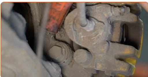
**8** Lösen Sie die Befestigung der Sattelhalterung. Verwenden Sie Stecknuss Nr. 18. Verwenden Sie ein Windeisen.
