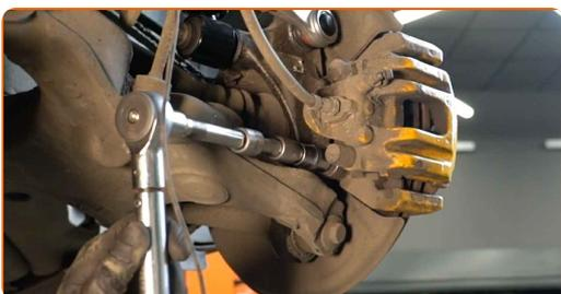
**28** Verbinden Sie den Bremsbelag-Verschleiß-Sensor.
