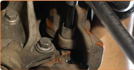
**22** Installieren Sie die Staubschutzkappen der Bremssattel-Führungsstifte.
