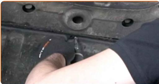
9 Entfernen Sie den Motorspritzschutz.
