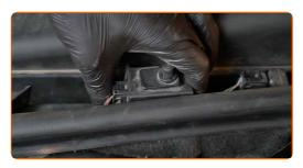
Befestigen Sie die Clips der Innenraumfilterabdeckung.
