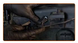
Entfernen Sie den Gehäusedeckel des Innenraumfilters.
