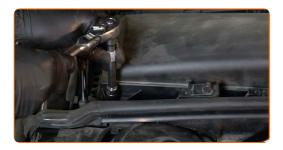
Lösen Sie die Clips der Innenraumfilterabdeckung.
