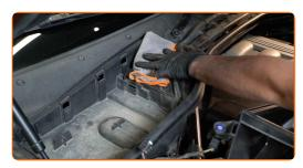
Das Kabinenfiltergehäuse und die Abdeckung reinigen.
