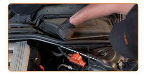
Entfernen Sie den Gehäusedeckel des Innenraumfilters.
