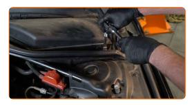
Lösen Sie die Clips der Innenraumfilterabdeckung.
