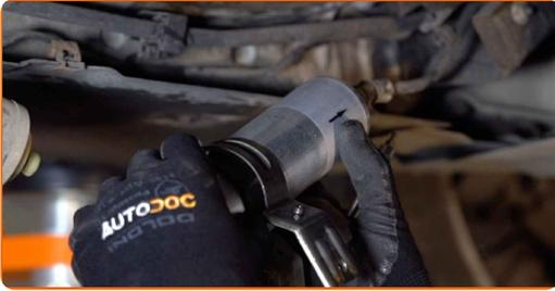
19 Ziehen Sie das Befestigungselement der Halterung des Kraftstofffilters an. Verwenden Sie den Torx T20. Verwenden Sie einen Ratschenschlüssel.
