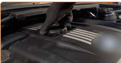
**33** Lassen Sie den Motor ein paar Minuten laufen. Nachdem die Ölstands-Warnleuchte erloschen ist, stoppen Sie den Motor.
