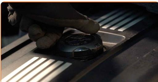
**4** Schrauben Sie den Filtergehäusedeckel zusammen mit dem alten Filterelement ab. Verwenden Sie Steckschlüssel 86-16F. Verwenden Sie einen Ratschenschlüssel.
