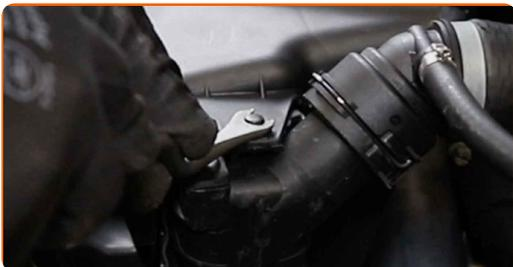
**5** Schrauben Sie die Befestigung des Kühlgebläses ab. Verwenden Sie Ring-Gabelschlüssel Nr. 32 (2 Teile).
