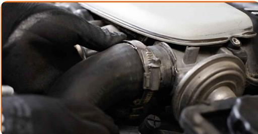
**48** Schrauben Sie die Klemme des Ladeluftkühlerschlauchs an. Verwenden Sie Stecknuss Nr. 7. Verwenden Sie einen Ratschenschlüssel.
