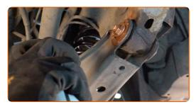
Entfernen Sie den Träger unter der Achsschenkelachse.
