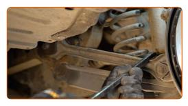
Entfernen Sie den Träger unter der Achsschenkelachse.
