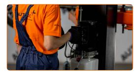
Stützen Sie die Achsschenkelachse auf. Benutzen Sie einen hydraulischen Getriebeheber.
