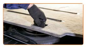
Schrauben Sie die Befestigungsschrauben der Schutzabdeckung ab. Verwenden Sie Stecknuss Nr. 10. Verwenden Sie einen Ratschenschlüssel.
