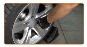
52 Entfernen Sie den Wagenheber sowie die Unterlegkeile.
