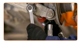
8 Entfernen Sie die Befestigungsschraube.
