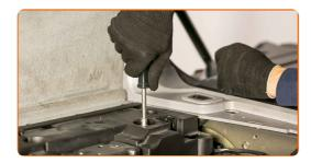
16 Entfernen Sie die Abdeckung der Seitenauskleidung des Kofferraums.
