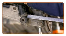
Lösen Sie den unteren Teil des Stoßdämpfers. Benutzen Sie ein Brecheisen.
