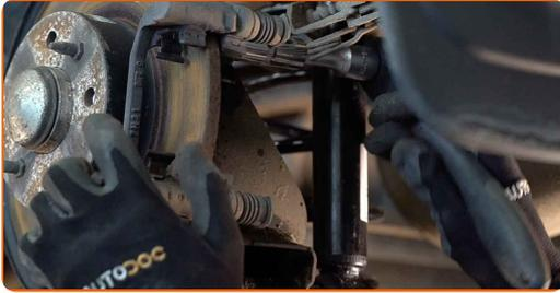
**12** Entfernen Sie die Sattelhalterung.
