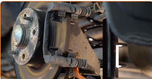
**11** Lösen Sie die Befestigung der Sattelhalterung. Verwenden Sie Stecknuss Nr. 17. Verwenden Sie ein Windeisen.
