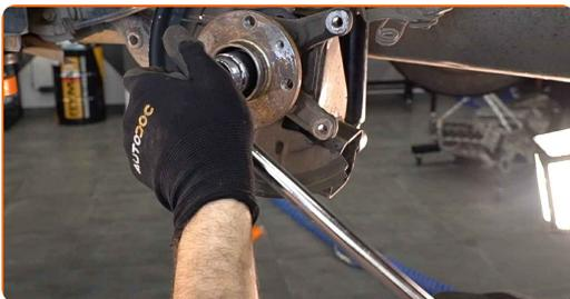
**18** Entfernen Sie die Nabe und das Lager zusammen, da sie eine versiegelte Einheit sind.
