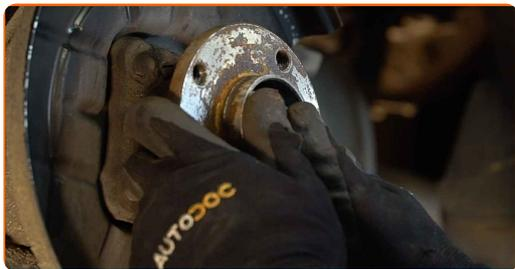
**19** Reinigen Sie den Einbauort für die Nabenlagerung. Verwenden Sie Allzweckreinigungsspray.
