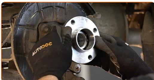
**21** Ziehen Sie die Nabe hindurch. Verwenden Sie Stecknuss Nr. 32. Verwenden Sie einen Drehmomentschlüssel. Ziehen Sie ihn mit 224 Nm Drehmoment fest.
