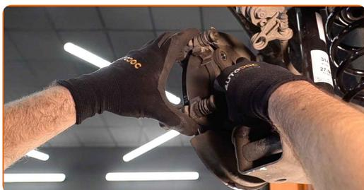
**28** Befestigen Sie die Bremssattelhalterung. Verwenden Sie Stecknuss Nr. 17. Verwenden Sie einen Drehmomentschlüssel. Ziehen Sie ihn mit 62 Nm Drehmoment fest.
