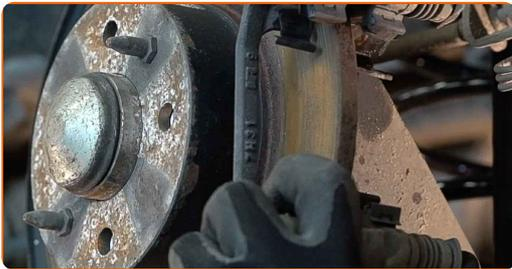
**13** Reinigen Sie die Befestigungselemente der Bremsscheibe. Benutzen Sie eine Drahtbürste. Benutzen Sie WD-40-Spray.
