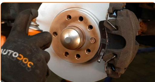
**24** Die Bremsscheibenoberfläche reinigen. Benutzen Sie einen Bremsenreiniger.
