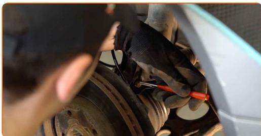
**21** Den Stoßdämpfer entfernen.
