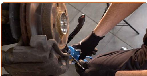
**20** Lösen Sie den unteren Teil des Stoßdämpfers. Verwenden Sie einen flachen Schraubendreher.
