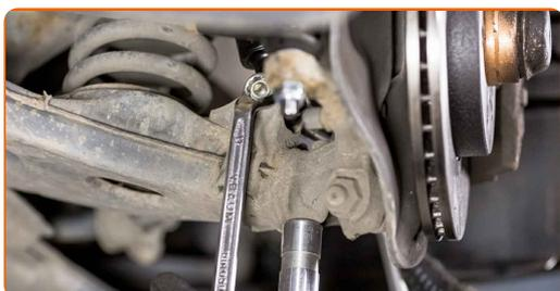
**36** Entfernen Sie den Träger unter dem Arm.
