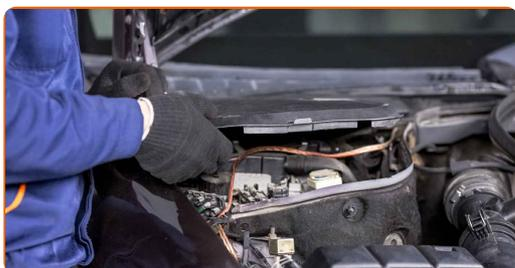
**16** Reinigen Sie die Befestigungen vom Stoßdämpferschaft. Benutzen Sie eine Drahtbürste. Benutzen Sie WD-40-Spray.
