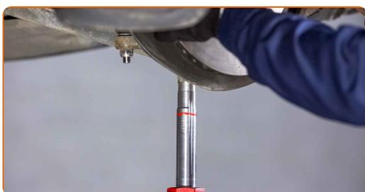
**34** Bringen Sie die Befestigungsschraube an. Verwenden Sie einen flachen Schraubendreher.
