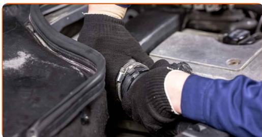
**6** Schrauben Sie die Klemme, die den Luftfilterschlauch an der Drosselklappe befestigt, ab. Verwenden Sie einen flachen Schraubendreher.
