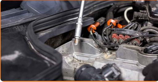
**17** Schrauben Sie die neuen Zündkerzen an und ziehen Sie diese fest. Verwenden Sie die Zündkerzennuss # 16. Verwenden Sie einen Drehmomentschlüssel. Ziehen Sie ihn mit 27 Nm Drehmoment fest.
