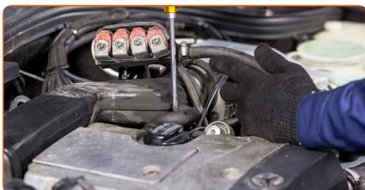
**7** Lösen Sie das Vakuumrohr. Verwenden Sie einen flachen Schraubendreher.
