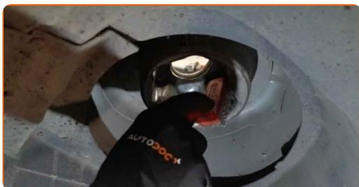
**39** Installieren Sie das Federbein am Radlauf.
