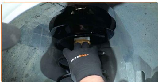
**40** Schrauben Sie die obere Befestigung des Federbeinbefestigung an. Schrauben Sie diese nicht fest.
