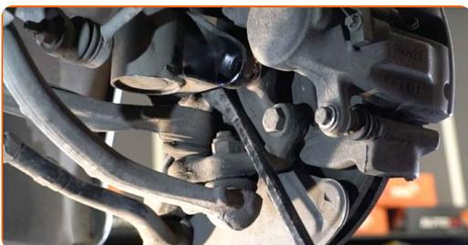
**22** Stützen Sie die Achsschenkel auf. Benutzen Sie einen hydraulischen Getriebeheber.
