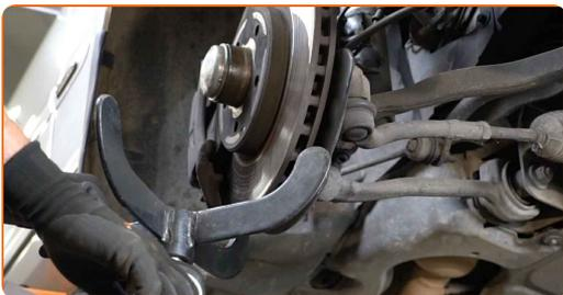
**23** Entfernen Sie die Befestigungsschraube.
