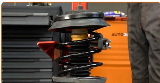
**37** Entfernen Sie das zusammengebaute Federbein.
