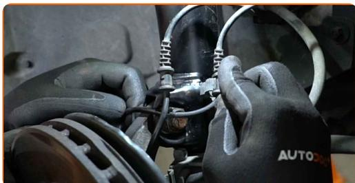
**53** Verbinden Sie das Bremsbelagverschleißkabel.
