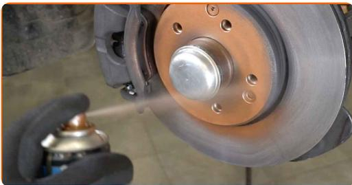
**59** Die Bremsscheibenoberfläche reinigen. Benutzen Sie einen Bremsenreiniger.
