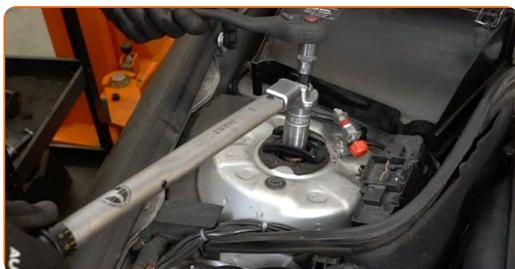
**65** Behandeln Sie die Befestigungselemente des Federbeinstützlagers. Benutzen Sie ein Kupferschmiermittel.
