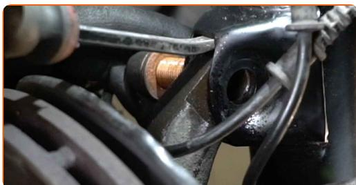
**44** Schrauben Sie die obere Befestigung ein, die das Federbein mit dem Achsschenkel verbindet. Verwenden Sie Stecknuss Nr. 21. Verwenden Sie Inbusschlüssel Nr. H12. Verwenden Sie einen Ratschenschlüssel.
