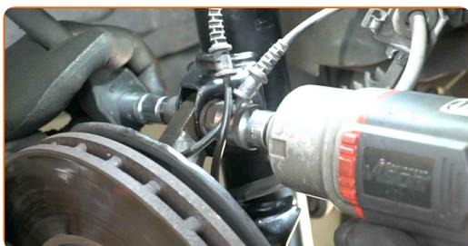
**45** Entfernen Sie den Träger unter dem Achsschenkel.
