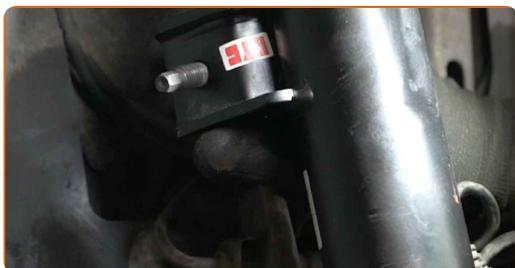
**56** Ziehen Sie das Befestigungselement an, das die Druckstange mit dem Federbein verbindet. Verwenden Sie Stecknuss Nr. 16. Verwenden Sie einen Drehmomentschlüssel. Ziehen Sie ihn mit 60 Nm Drehmoment fest.
