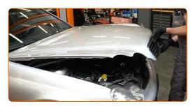
Verwenden Sie eine Kotflügel-Schutzabdeckung, um Schäden an der Lackierung und den Kunststoffteilen des Autos zu verhindern.
