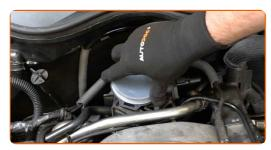
Lösen Sie die Steckverbindung von den Zündspulen.
