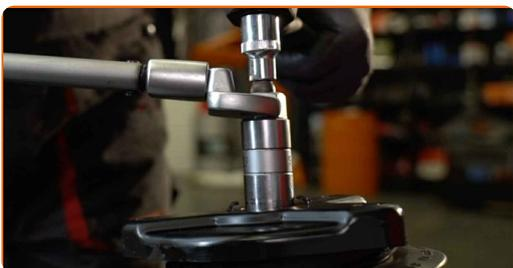
**35** Dekomprimieren Sie die Feder.
