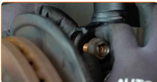
**44** Ziehen Sie die unteren Befestigungen an, die das Federbein mit dem Achsschenkel verbinden. Verwenden Sie Stecknuss Nr. 21. Verwenden Sie den Torx E18. Verwenden Sie einen Drehmomentschlüssel. Ziehen Sie ihn mit 100 Nm Drehmoment fest.+90°
