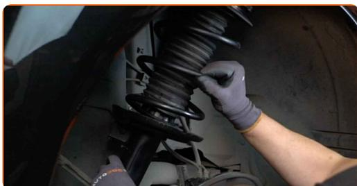
**41** Sichern Sie die oberen Befestigungen des Federbeines. Schrauben Sie diese nicht fest. Verwenden Sie den Torx E12. Verwenden Sie einen Ratschenschlüssel.
