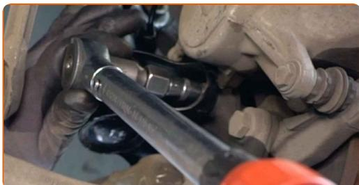
**45** Ziehen Sie die unteren Befestigungen an, die das Federbein mit dem Achsschenkel verbinden. Verwenden Sie den Torx E14. Verwenden Sie einen Drehmomentschlüssel. Ziehen Sie ihn mit 100 Nm Drehmoment fest.
