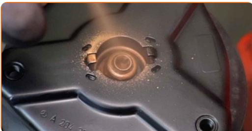
**37** Montieren Sie die Staubschutzkappe an der Federbeinhalterung.
