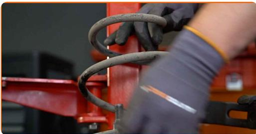
**30** Installieren Sie die Feder am Stoßdämpfer.
