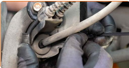
**48** Montieren Sie den Querlenker.
