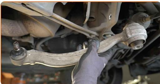
**14** Reinigen Sie die Montagesitze des Querlenkers. Benutzen Sie eine Drahtbürste. Benutzen Sie WD-40-Spray.
