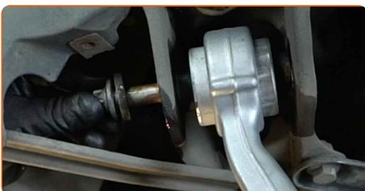
**17** Verbinden Sie das Kugelgelenk mit dem Achsschenkel.
