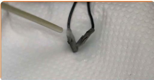
**9** Schließen Sie die Steckverbindungen der Spiegelheizung wieder an.
