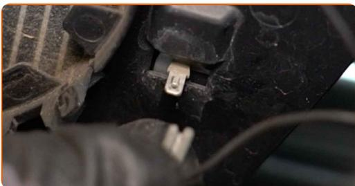
**8** Behandeln Sie die Steckverbindungen der Spiegelheizung. Verwenden Sie dielektrisches Fett.
