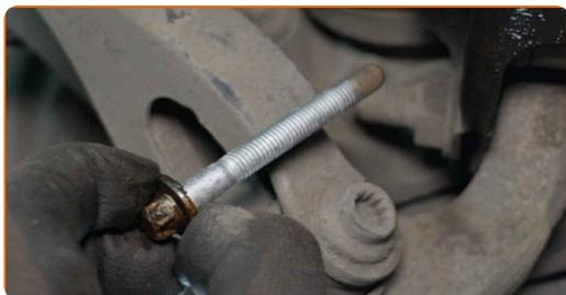
**9** Schrauben Sie das Befestigungselement heraus, das die Druckstange mit dem Stabilisator verbindet. Verwenden Sie Ring-Gabelschlüssel Nr. 16. Verwenden Sie Ring-Gabelschlüssel Nr. 22.
