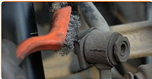
**7** Drehen Sie das Befestigungselement auf, das die Koppelstange mit dem Querlenker verbindet. Verwenden Sie Stecknuss Nr. 13. Verwenden Sie den Torx E12. Verwenden Sie einen Ratschenschlüssel.
