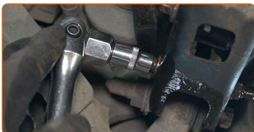
**8** Entfernen Sie die Befestigungsschraube.
