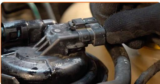
**17** Befestigen Sie die Leitung am Kraftstofffilter.
