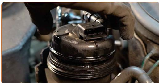
**15** Verbinden Sie die Kraftstoffleitungen zum Kraftstofffilter und verriegeln Sie die Befestigungsklammern.
