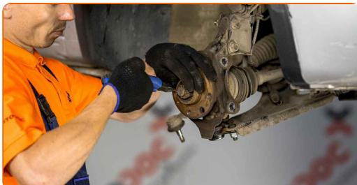
**42** Installieren Sie den ABS-Sensor am Achsschenkel und sichern Sie diesen.
