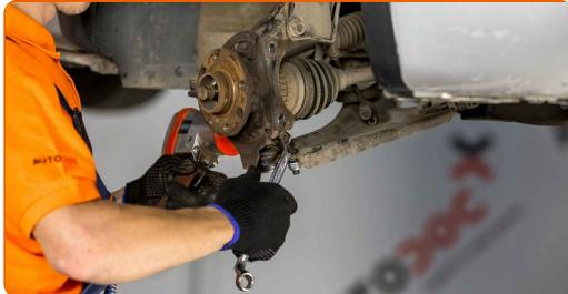
**40** Schrauben Sie die Nabennutter an. Verwenden Sie Stecknuss Nr. 30. Verwenden Sie einen Drehmomentschlüssel. Halten Sie das empfohlene Anzugsdrehmoment ein.
