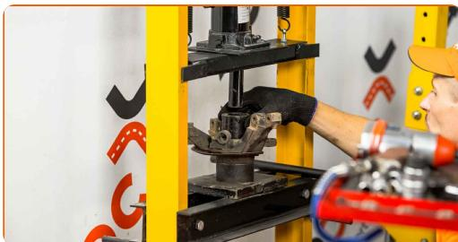
Austausch: Radlager – Opel Corsa C. AUTODOC-Experten empfehlen:
